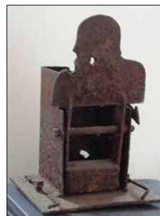
Original-Kugelfang für Luftdruckwaffen. Der Kugelfang der Schießstätte war 90x90cm.
